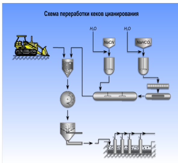
Рис. 1. Схема переработки техногенного минерального сырья (на примере кеков цианирования)
