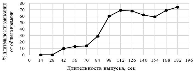
Рисунок 25 – График зависимости процента длительности зависаний от продолжительности единичного выпуска
