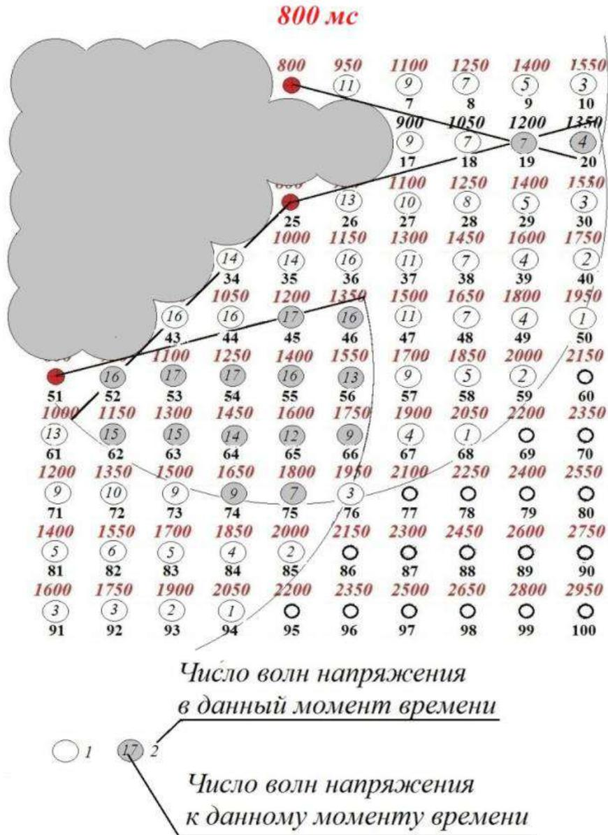
Рис. 3.6. Развитие взрыва к 800 мс при схеме инициирования  $150 \times 200$  мс
