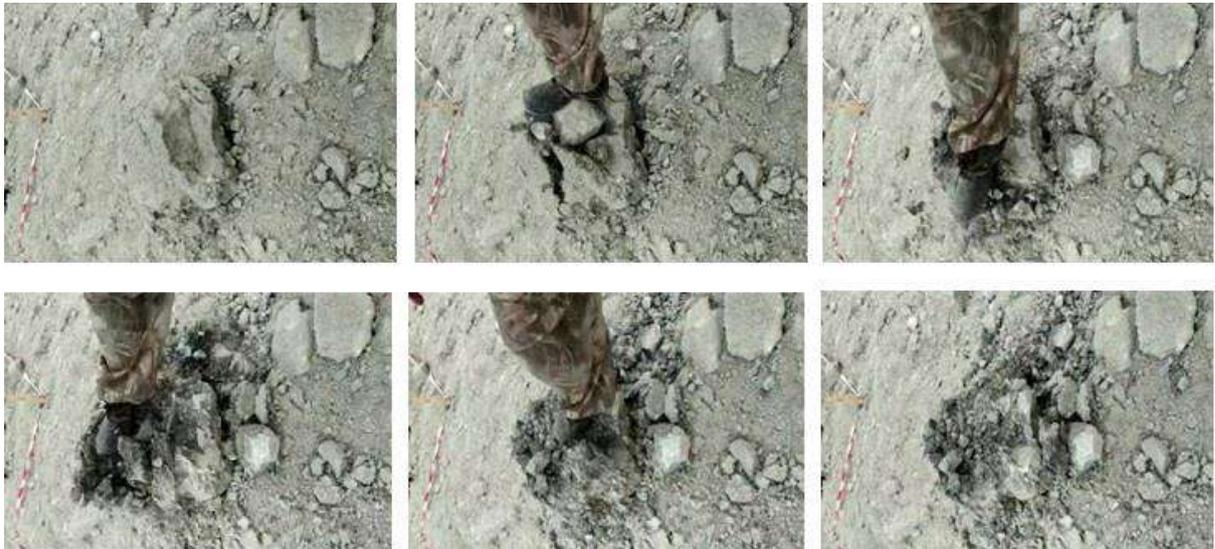
Рис. 4.25. Разрушение камня на поверхности развала ударами ноги
