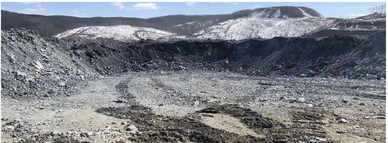
Рис. 4.21. Подошва уступа высотой 5 м, взорванного по сетке скважин 6,5х6,5 м
