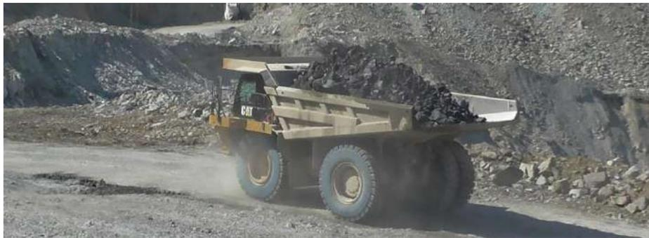
Рис. 3.31. Вскрышные породы в кузове автосамосвала
