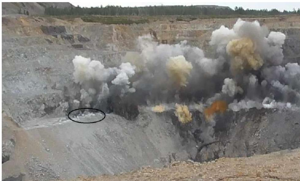
Рис. 3.37. Отсутствие выбросов из скважин без забойки в конце блока
