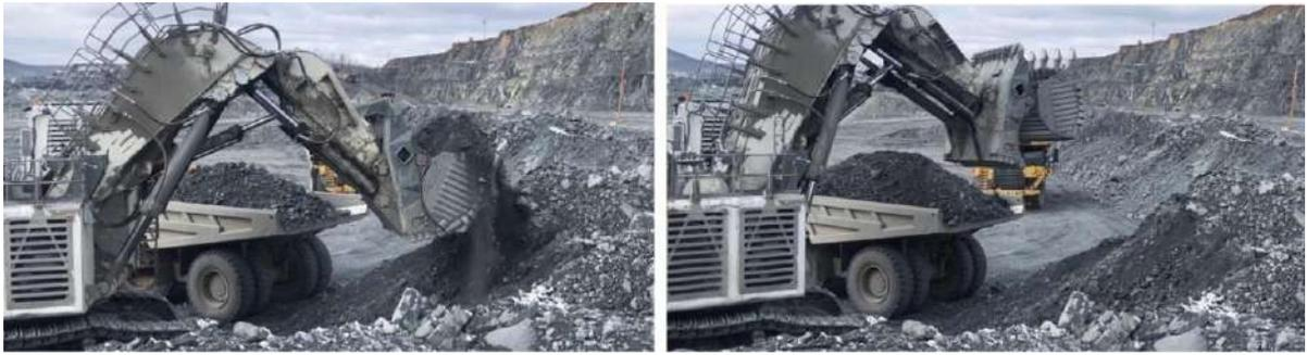
Рис. 4.22. Выемка горной массы блока № 9, взорванного по сетке 6,5х6,5 м
