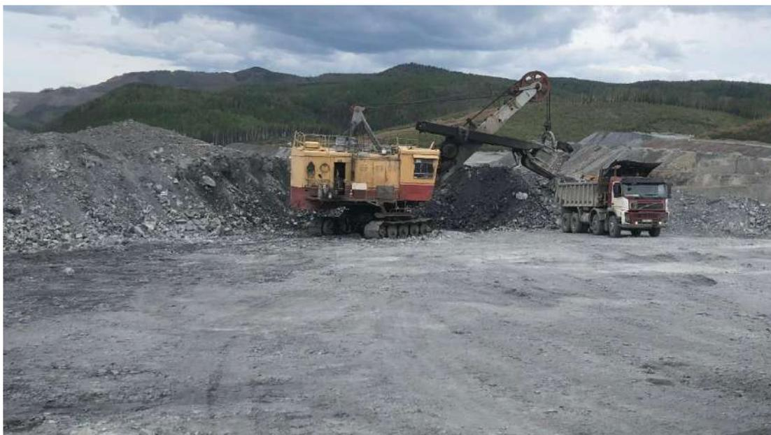
Рис. 3.47. Подошва уступа высотой 5 м у прямой механической лопаты
