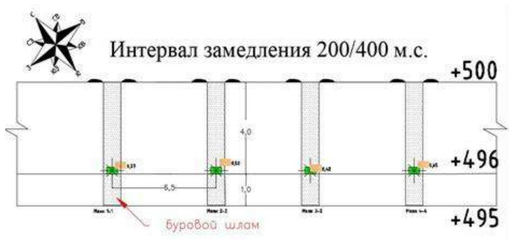
Рис. 4.18. Расстановка маяков в специальных скважинах
