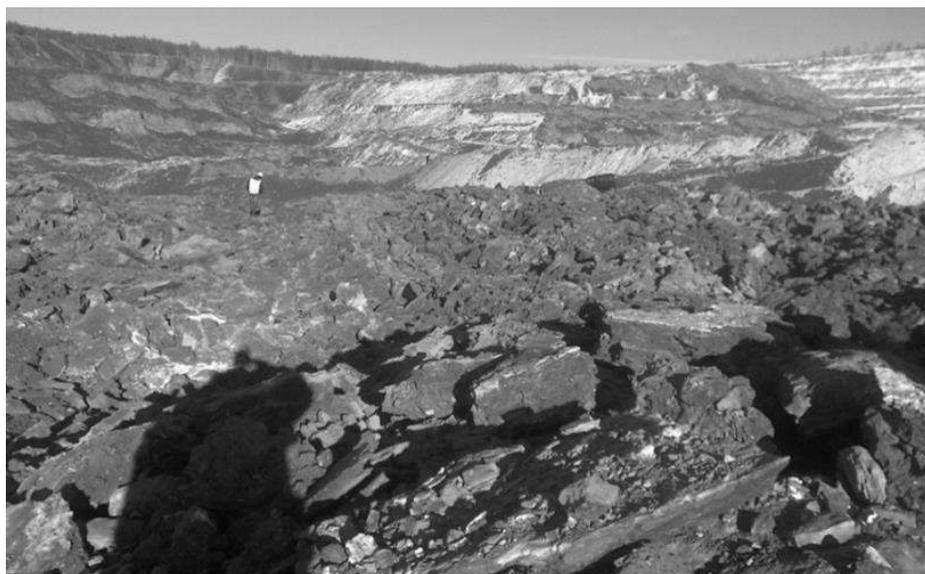
Рис. 2.6. Поверхность развала горной массы при схеме взрывания 275×300 мс
