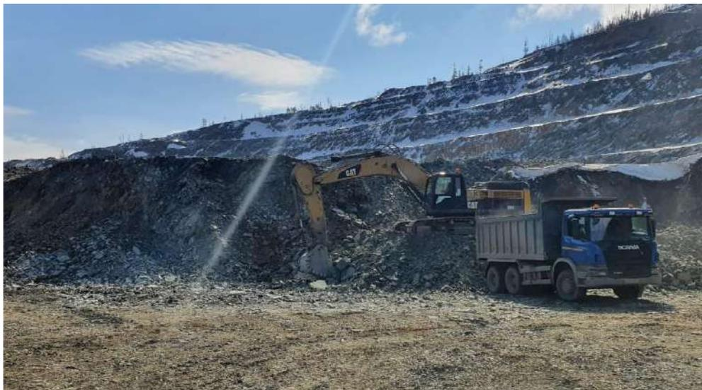
Рис. 3.48. Подошва уступа высотой 5 м у обратной гидравлической лопаты
