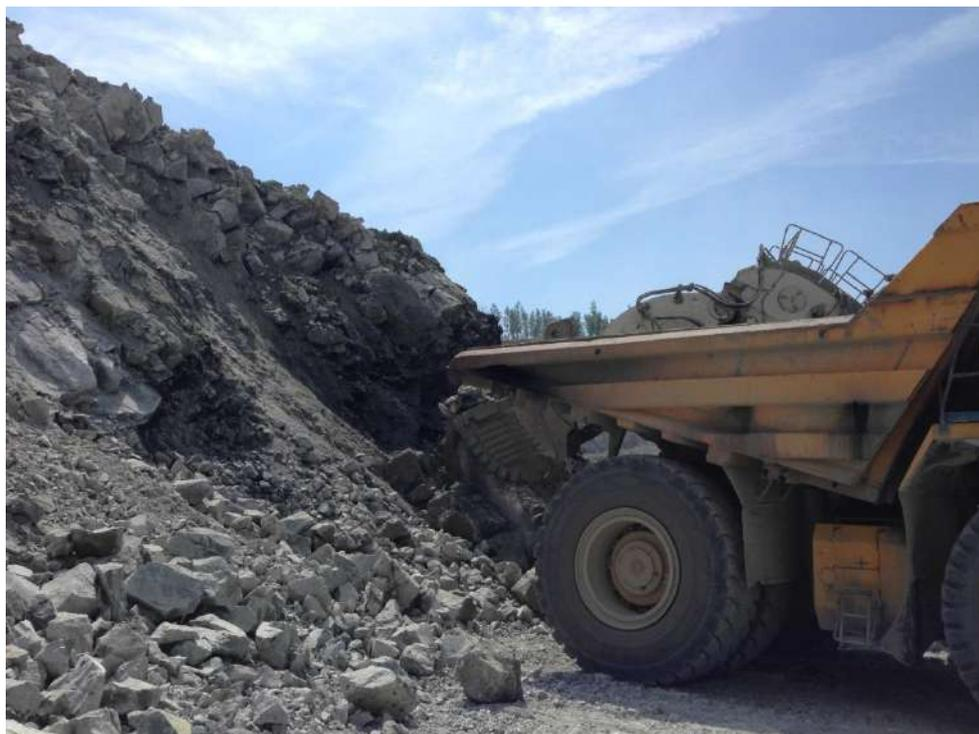
Рис. 3.40. Вид экскаваторного забоя после взрыва по схеме  $42 \times 67$  мс
