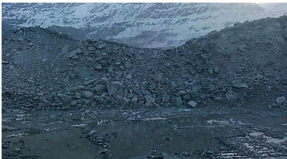
Рис. 3.41. Развал горной массы после взрыва по схеме  $42 \times 67$  мс
