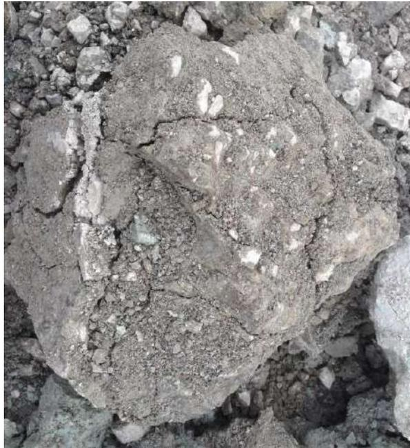
Рис. 4.24. Камень на поверхности развала горной массы после взрыва по схеме 200×400 мс
