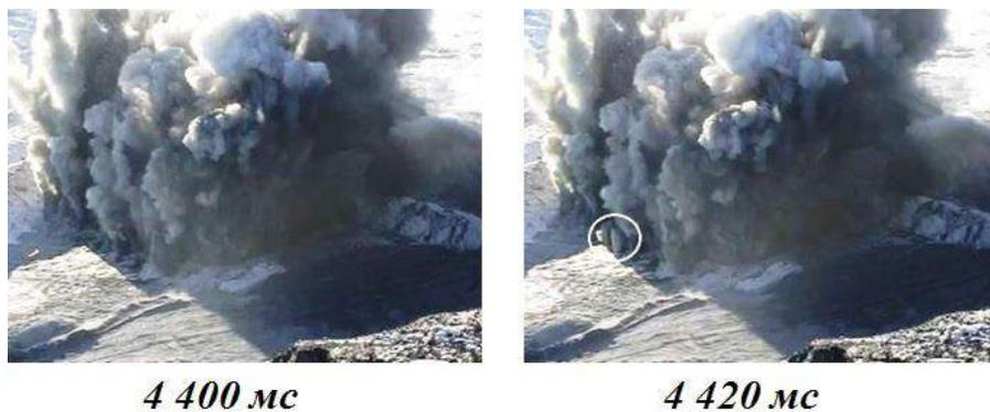
Рис. 2.10. Одновременный взрыв соседних скважин блока № 23
