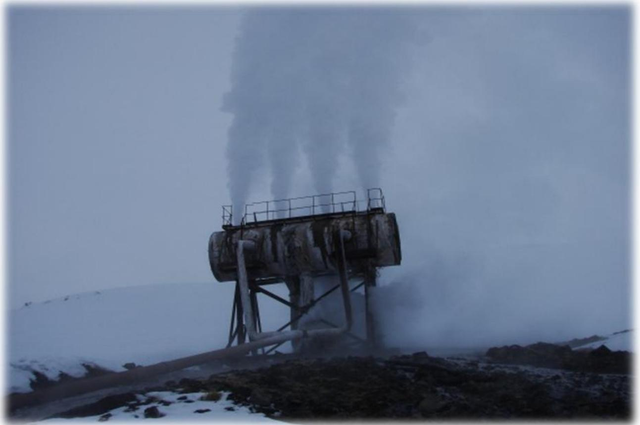
*Рисунок 4.1 – Общий вид установки С-100-0,5 для испытания скважин*
