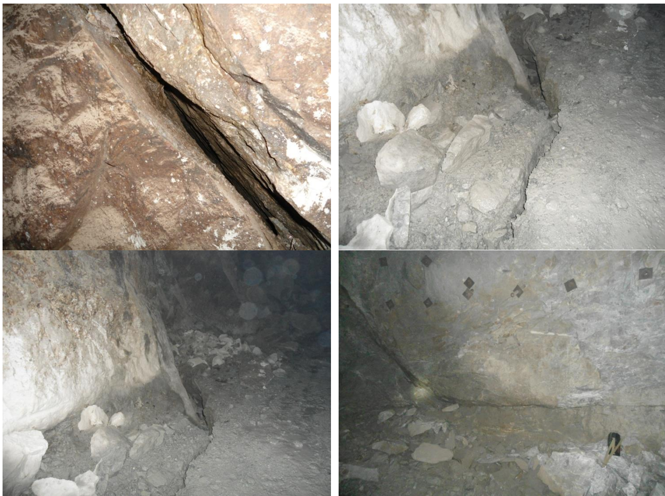
Рисунок 1.2.1 – Разрывные нарушения в массиве Николаевского месторождения, образованные в результате проявления техногенной сейсмичности 25.03.2016 г.
