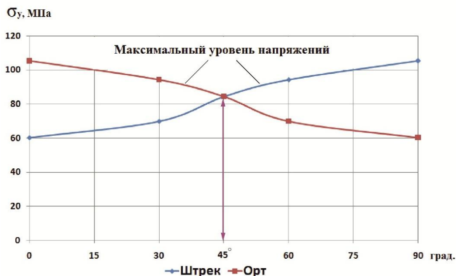
Рисунок 4.1.1 – График распределения максимальных горизонтальных напряжений \sigma_y в кровле ортов и штреков, расположенных на глубине 800 м, в зависимости от их ориентировки к главным сжимающим напряжениям
