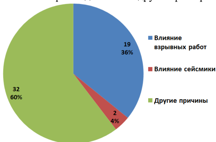
Рисунок 2.4.5 – Диаграмма влияния взрывных работ и геосейсмики на удароопасность Николаевского месторождения
