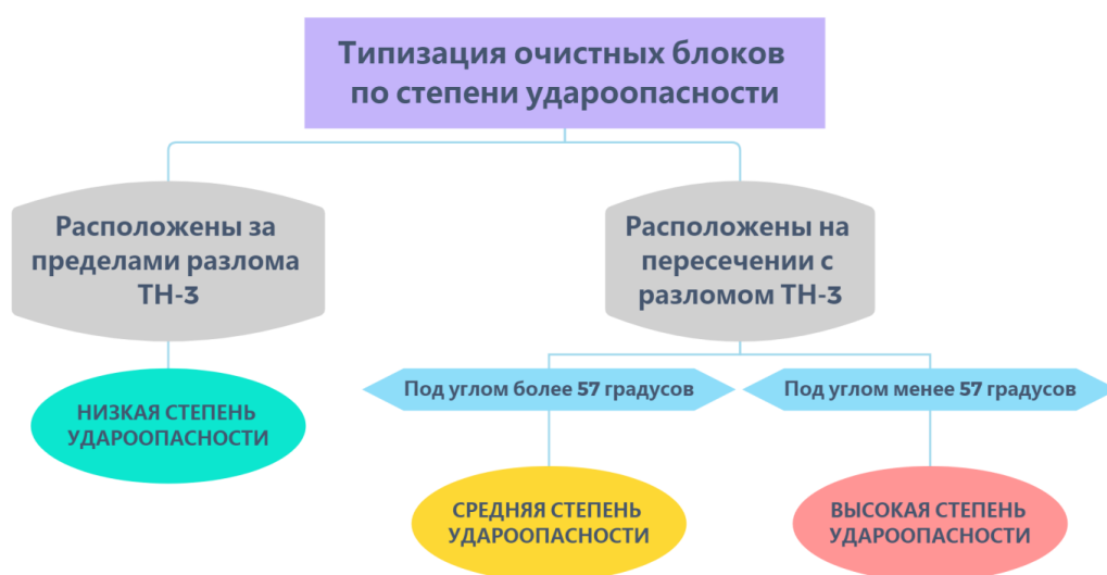
Рисунок 4.3.1 – Блок-схема типизации очистных блоков по степени их удароопасности (величина угла условно принята для массива известняка)
