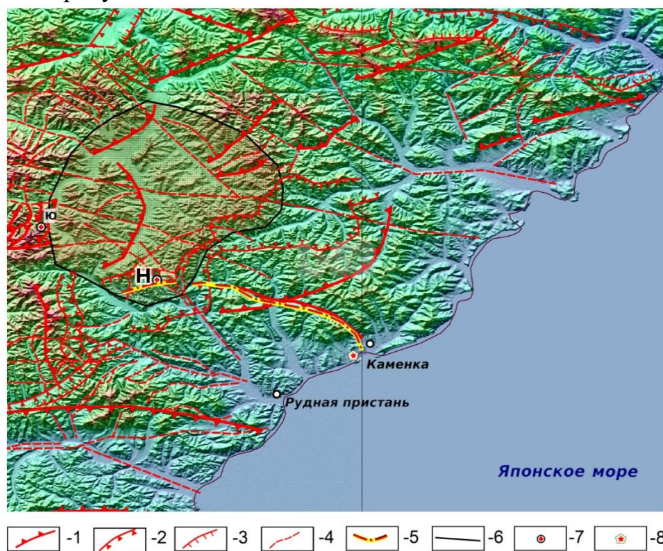
Рисунок 2.1.3 – Морфоструктурная схема Кавалеровско-Дальнегорского рудного узла, составленная на основе матрицы высот srtm03 - по Усикову В. И. [92]
